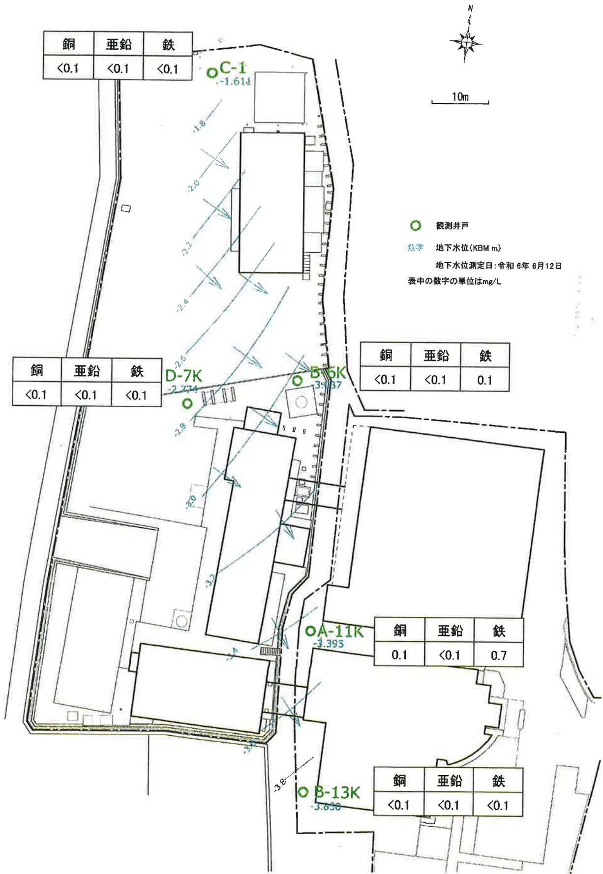
図 8.1 地下水流向推定図
